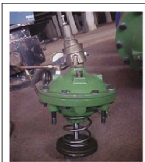
Figura 24 – foto de atuador de câmara dupla fora do corpo da válvula
