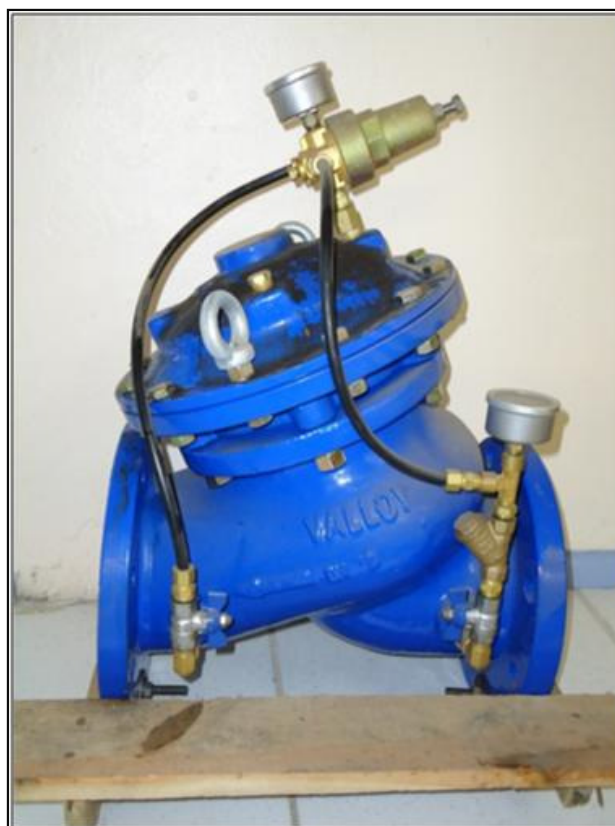
Figura 15 – Válvula Redutora de Pressão
