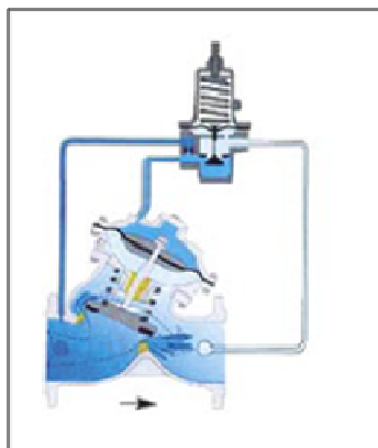
Figura 19 – Exemplo de válvula redutora de ação indireta (com válvula piloto)
