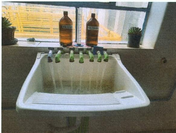
Figura 16: Torneiras para coleta de água para análise.
