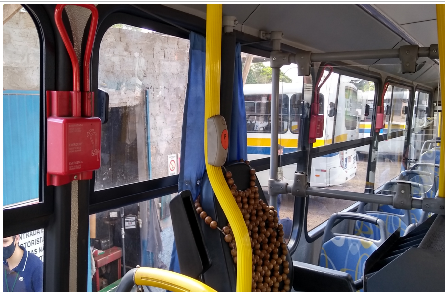
Foto 5 – Saídas de Emergência
