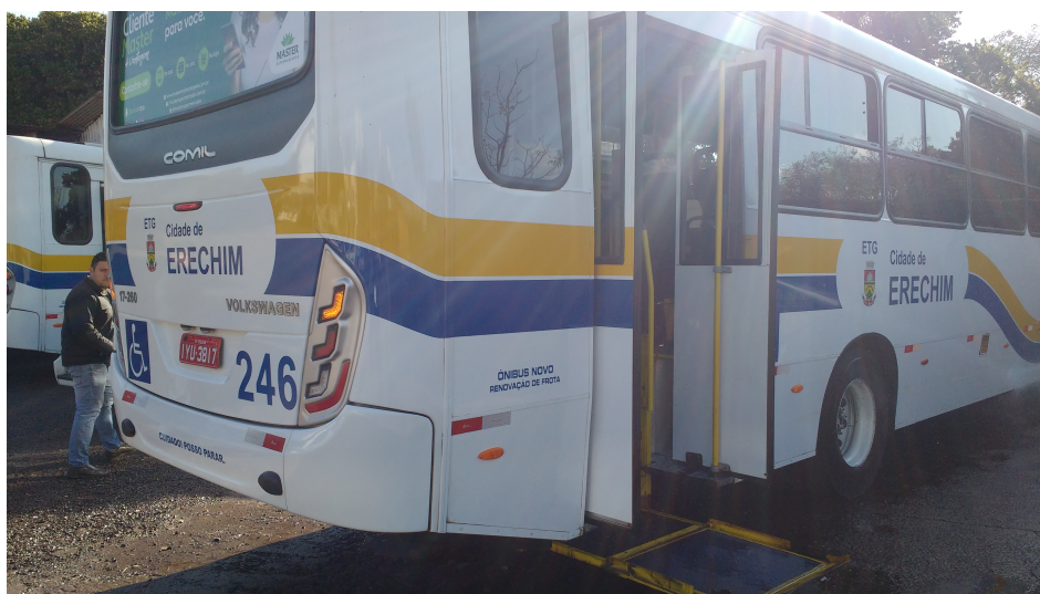
Foto 2 Veículo com a plataforma elevatória no nível para embarque/desembarque
